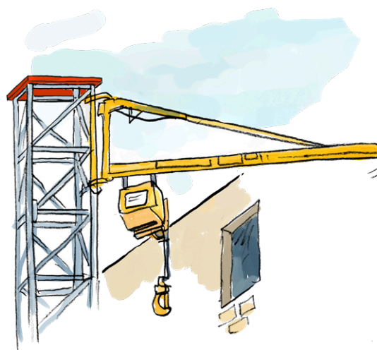
Sidemonteret kran og el-kædetalje.
